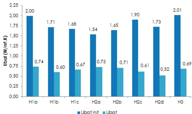
Figure 19 : Déperditions moyennes avant et après travaux par zones climatiques
